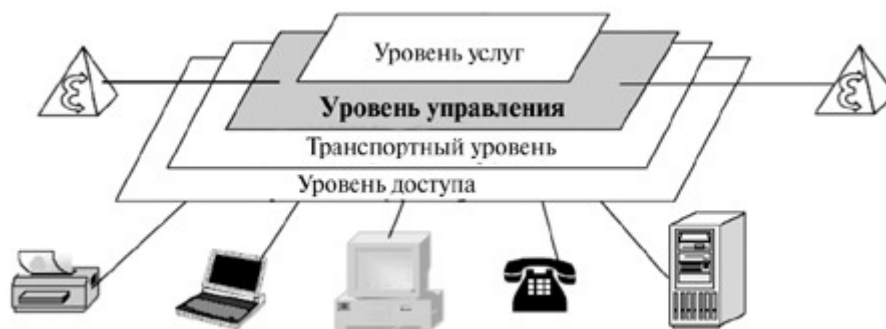
Рисунок 10.1 - Архитектура сети следующего поколения NGN
